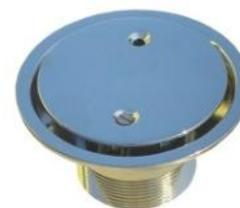
Bocchette di immissione dal fondo con foratura da 4 mm. Esecuzione ad incastro in acciaio Inox AISI 316 su tubazioni con Ø 50 - 90 mm. A richiesta si possono avere bocchette con portata fino a 30 m<sup>3</sup>/h
